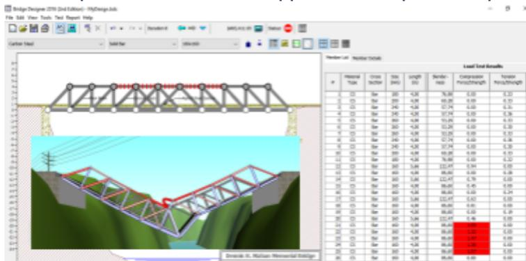
3. On **modifie la structure ou les matériaux** et on teste à nouveau pour vérifier jusqu'à obtenir une **déformation acceptable**.
