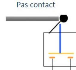
Soit l'objet est présent et vient appuyer sur la languette, soit il n'y a pas d'objet.
