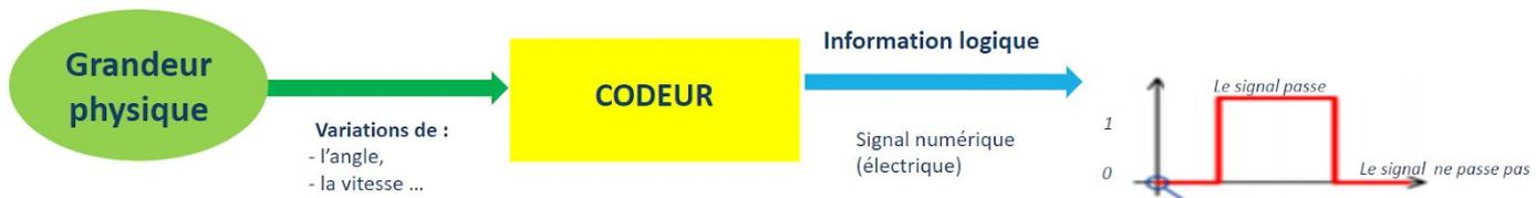
Principe de fonctionnement d'un codeur
