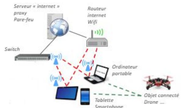
Les composants d'un réseau informatique nécessitent d'être connectés pour communiquer.
