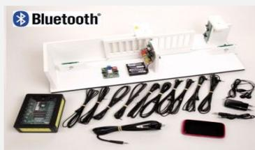
L'objet connecté doit comporter des **capteurs** et des **actionneurs** reliés à une **interface**. Pour le piloter, le **smartphone** ou l'**ordinateur** doit comporter une application.
